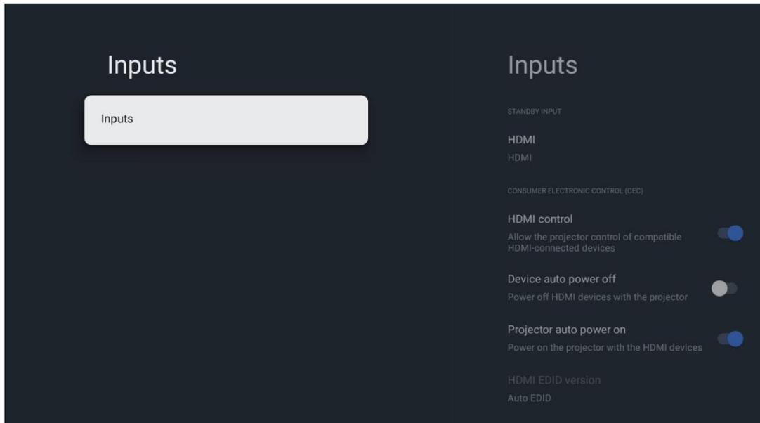
**Entrada conectada:** Veja os dispositivos listados ligados à ligação HDMI do seu projetor. Pode mudar o nome da ligação ou atribuir um nome de dispositivo individual a uma ligação específica.
